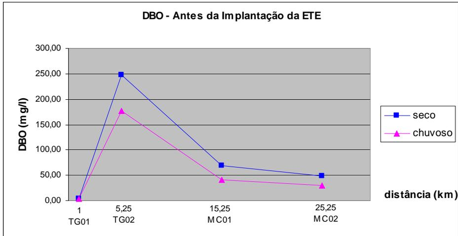
**Figura 18 - Perfil médio do DBO, antes da implantação da ETE Samambaia - Períodos seco e chuvoso.**
