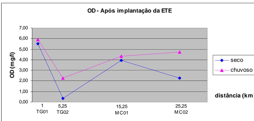
**Figura 17 - Perfil médio do OD, depois da implantação da ETE Samambaia - Períodos seco e chuvoso.**
