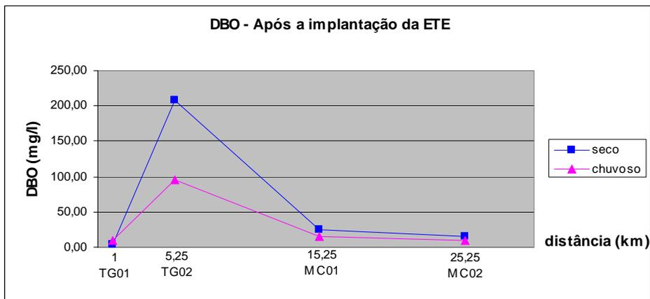
**Figura 19 - Perfil médio do DBO, após da implantação da ETE Samambaia - Períodos seco e chuvoso.**
