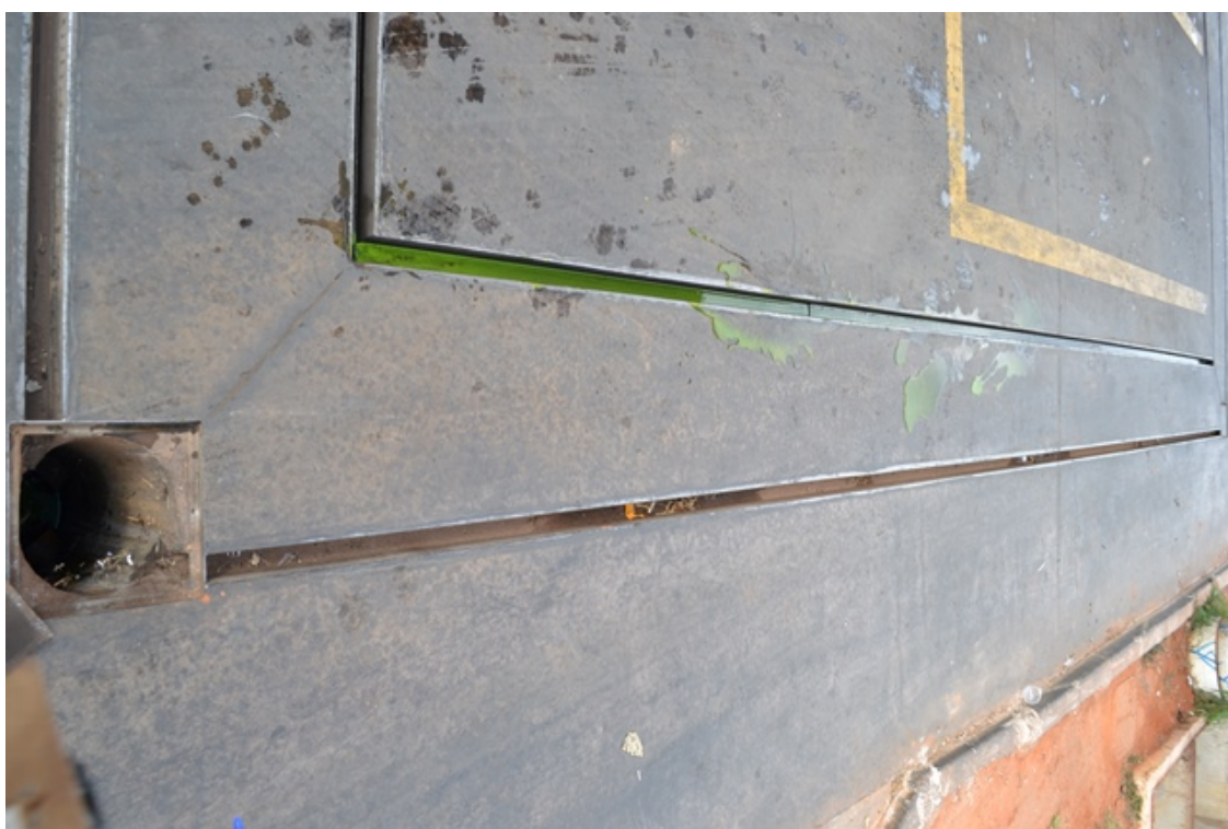
Figura 11: Teste com corante de funcionamento dos canaletes.
