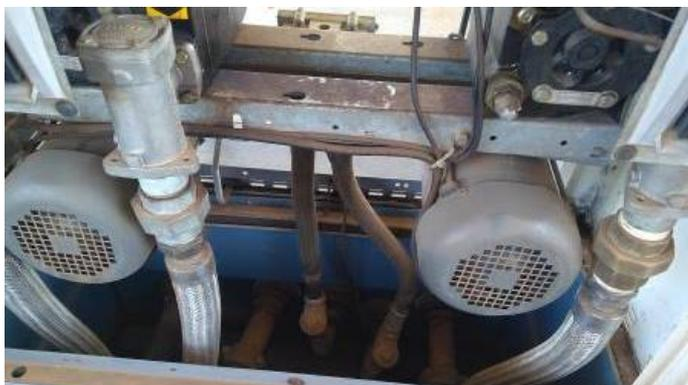
**Figura 4** – Aspecto interno de uma das Unidades abastecedoras com o dispositivo de segurança *Check-valve*.
