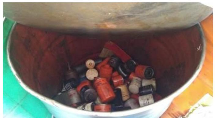
**Figura 39** - Aspecto geral dos tambores utilizados para o acondicionamento dos resíduos Classe I.
