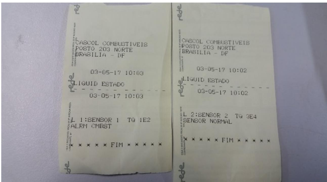
Figura 8 – Relatórios impressos no equipamento Veeder-Root do empreendimento com mensagem de erro no sensor 1
