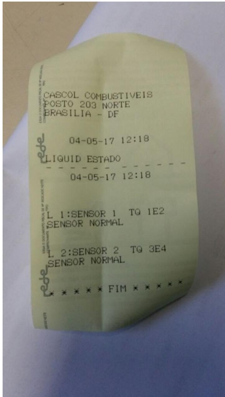
Figura 9 – Relatórios impressos no equipamento Veeder-Root do empreendimento com mensagem operação normal nos dois sensores intersticiais dos tanques.
