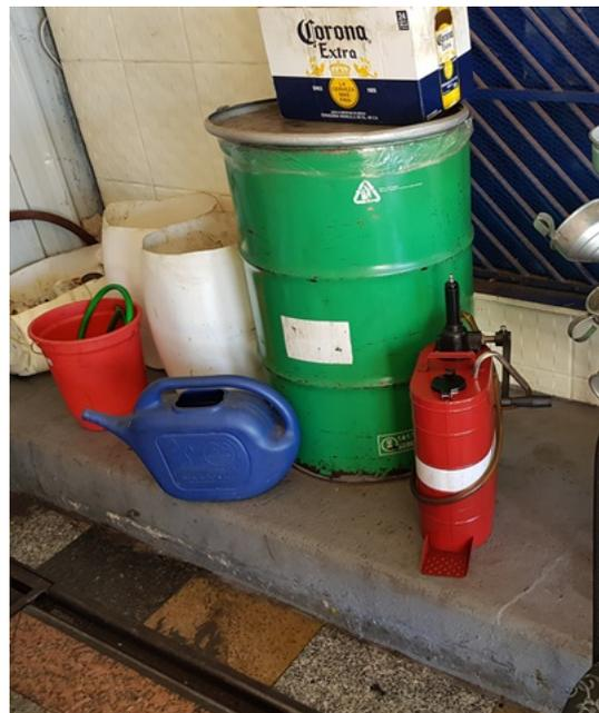
**Foto 33** - Equipamentos utilizados na troca de óleo, fora da abrangência dos canaletes
