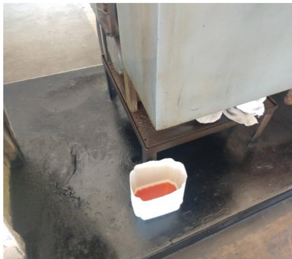
Foto 4. Detalhe do filtro de diesel com indícios de vazamento.
