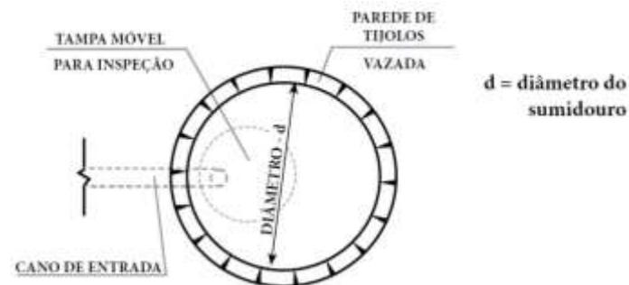
Planta Baixa Sumidouro – sem escala
