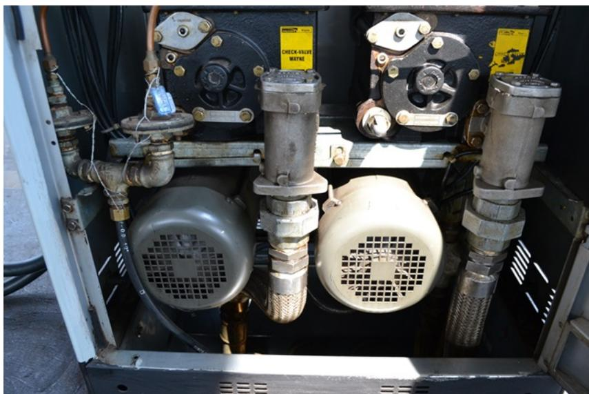
Foto 14-Válvula de retenção de bomba (Check Valve).
