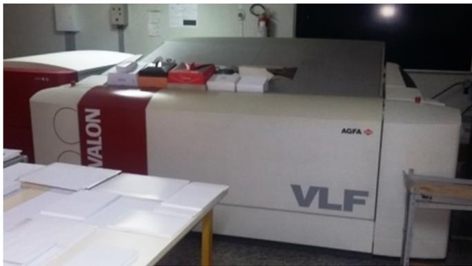
Foto 01 - Gravadora de chapas de impressão (método CTP).
