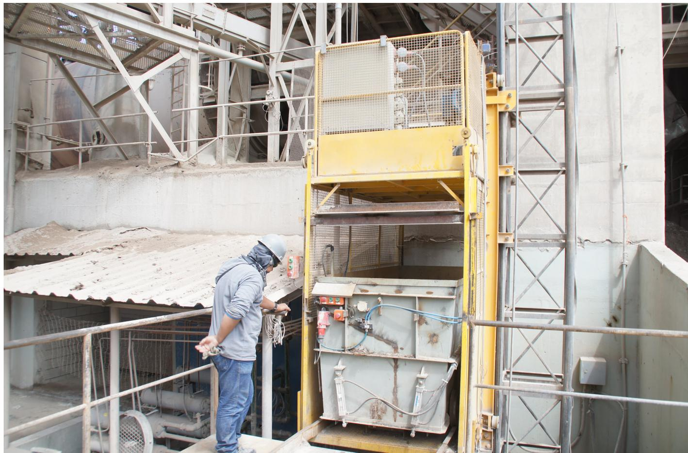
Foto 02 – Detalhe do elevador e da caçamba com o sistema elétrico de comando. Ao lado a torre metálica.
