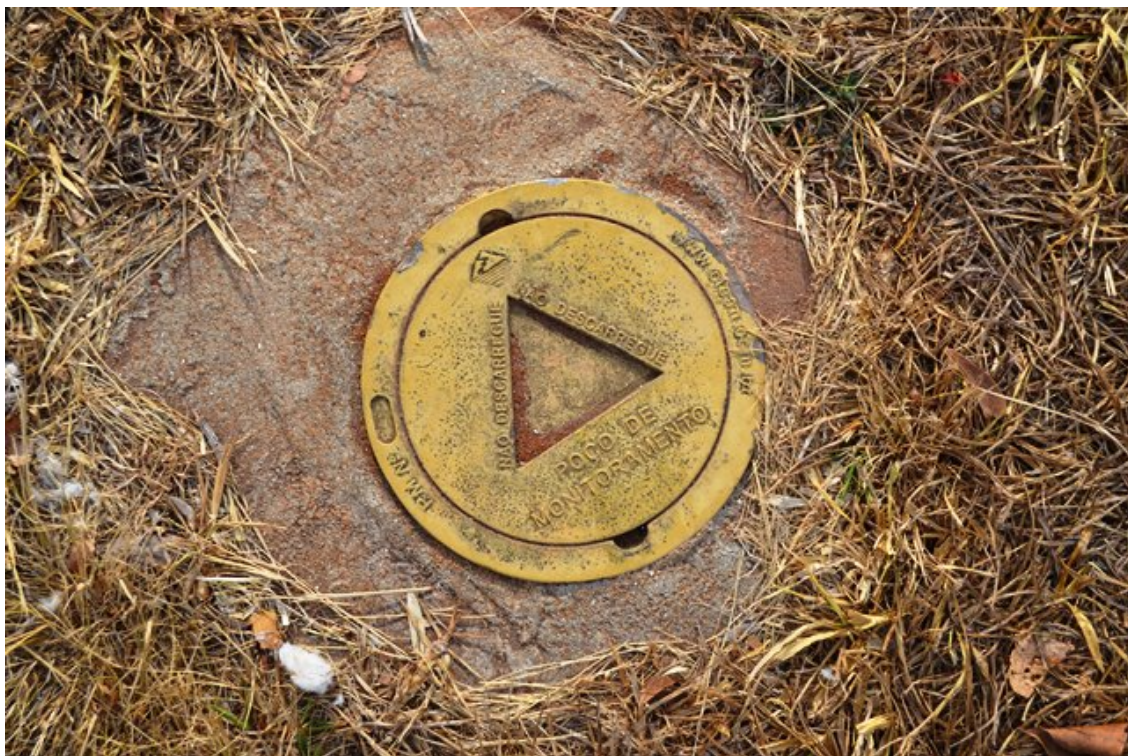
Figura 16 - Poço de Monitoramento Ambiental nº 08.
