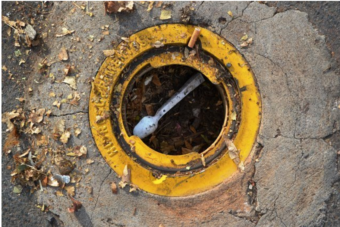
Figura 16 - Poço de Monitoramento Ambiental nº 13.
