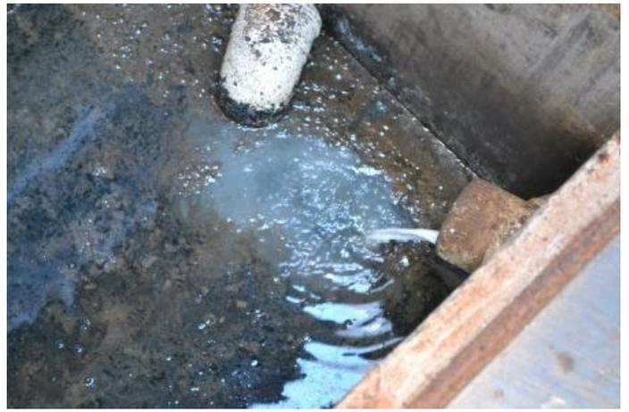
Foto 28 – Teste do funcionamento do SAO da pista de abastecimento
