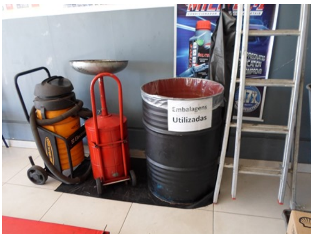
Foto 18: Detalhe da adequada segregação dos resíduos contaminados da área de lubrificação.
