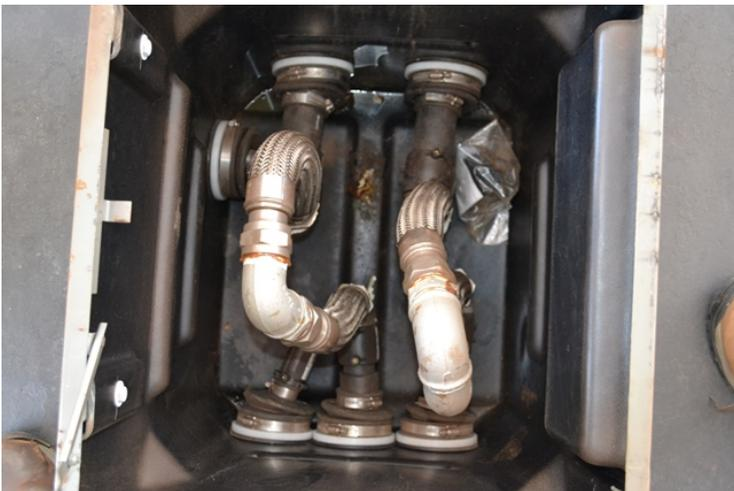
Foto 13 - Câmara de contenção do filtro de diesel, sem o filtro.
