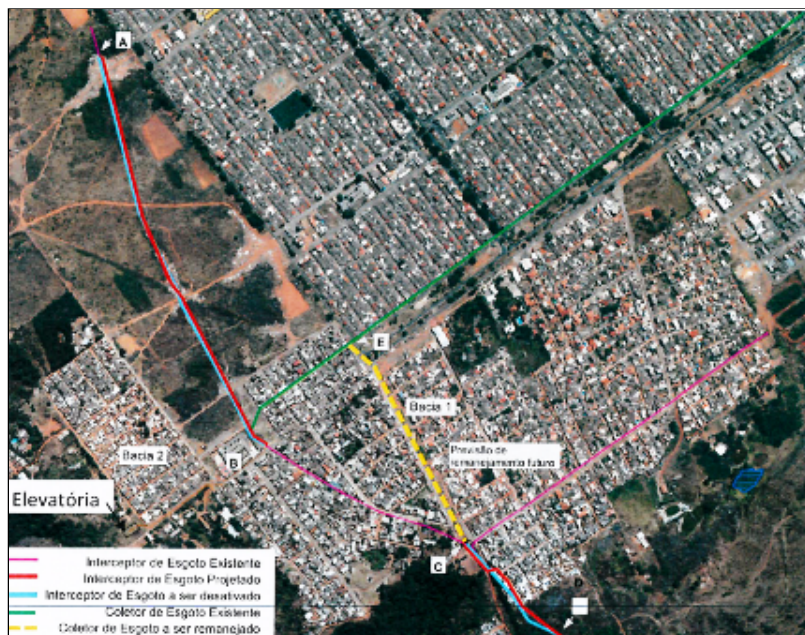
Figura 4 - Trechos do interceptor INT.CEI.001 (Fonte: CAESB)
