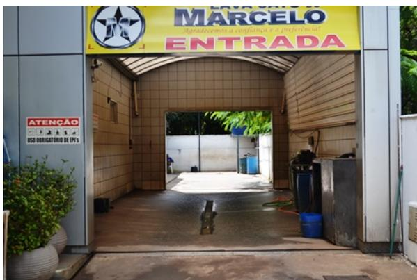
**Figura 18** - Vista da área de Lavagem de veículos, observa-se que a área possui caixa de areia central, cobertura e é cercada por canaletes com fluxo exclusivo para o SAO da área de lavagem conforme exige o parágrafo 4 art. 21 da instrução 213/2013.
