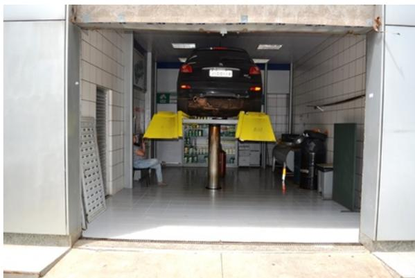
Figura 22 - Área de lubrificação de veículos com cobertura, canaletas, tanque OLUC e barril de armazenamento de embalagens de óleos usadas. Observa-se que o local é totalmente coberto.
