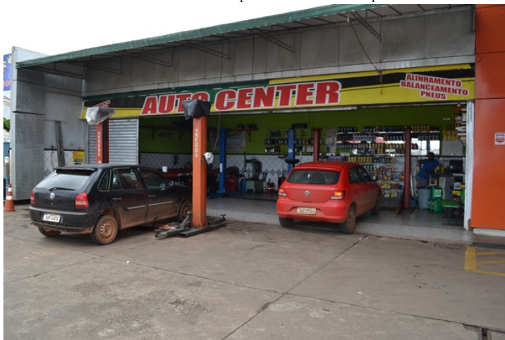
Foto 21. Área de lubrificação coberta e sem canaletos .
