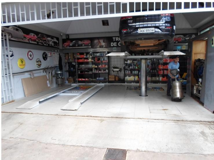
**Figura 12** - Área de lubrificação com piso impermeabilizado em bom estado de conservação com dois elevadores.
