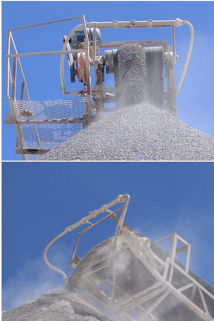
**Figura 16** - Exemplos de bicos aspersores com funcionamento inadequado. Os bicos aspersores estão localizados no cano com mangueiras nas duas extremidades. À esquerda sistema com bico entupido apenas com gotejamento de água e à direita sistema completamente sem lançamento de água.
