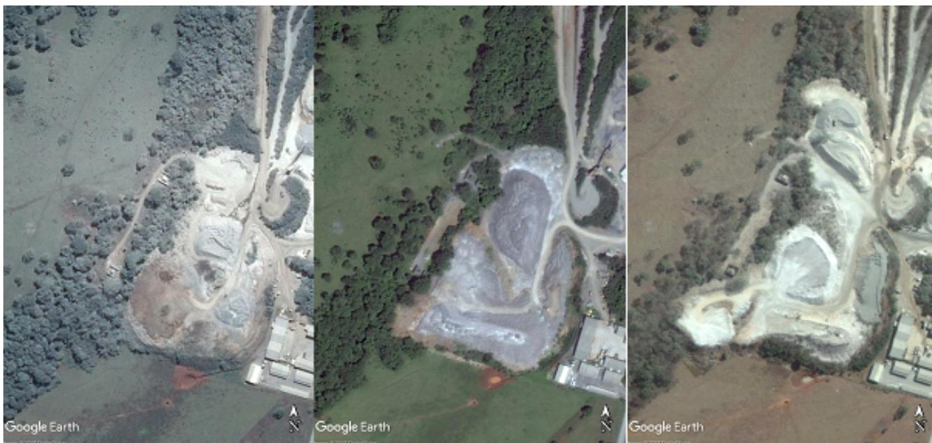
**Figura 2** - Depósito de Estéril em, da esquerda para a direita, 18/05/2013, 27/12/2014 e 30/06/2016. Notar o avanço do depósito sobre área de vegetação densa.
