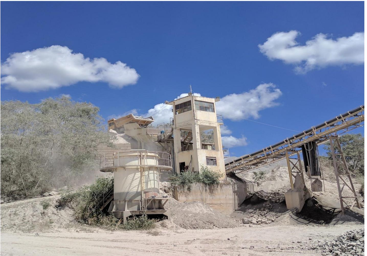
**Figura 12** - Britador primário. No topo da rampa, próximo a cabine de controle é possível ver um caminhão carregado de calcário proveniente da mina aguardando o momento de descarregar.
