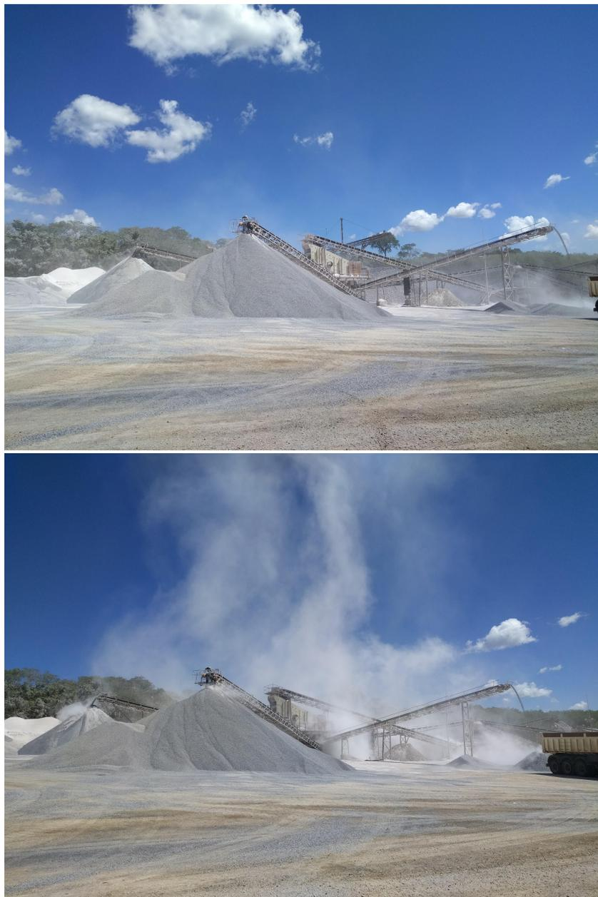
**Figura 15** - Comparação entre as emissões de material particulado no pátio de britagem com o sistema de aspersão ligado (esquerda) e desligado (direita). O sistema de Aspersão foi temporariamente desligado a pedido desta equipe.
