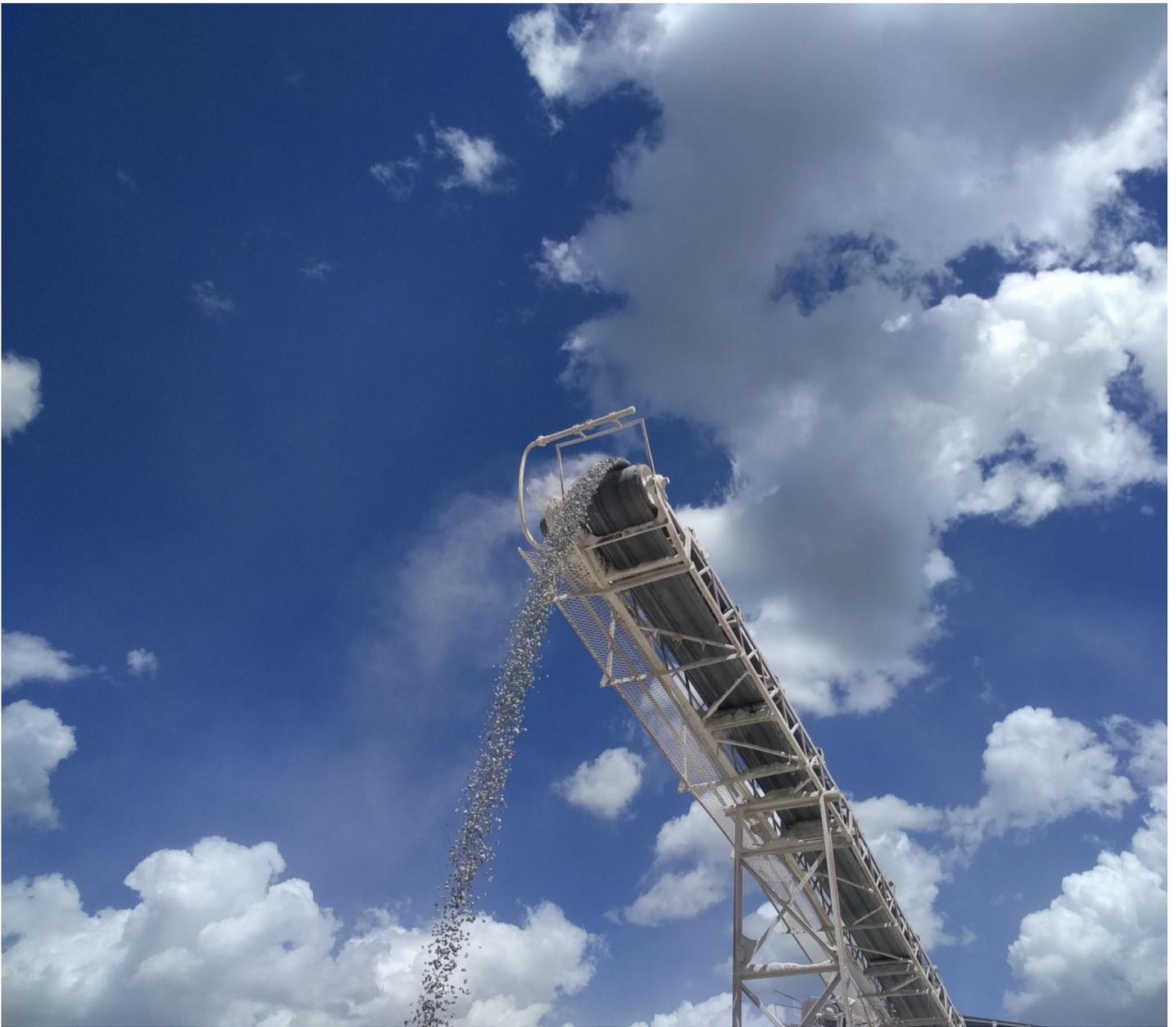
**Figura 13** - Ponto de lançamento de correia transportadora de material britado.
