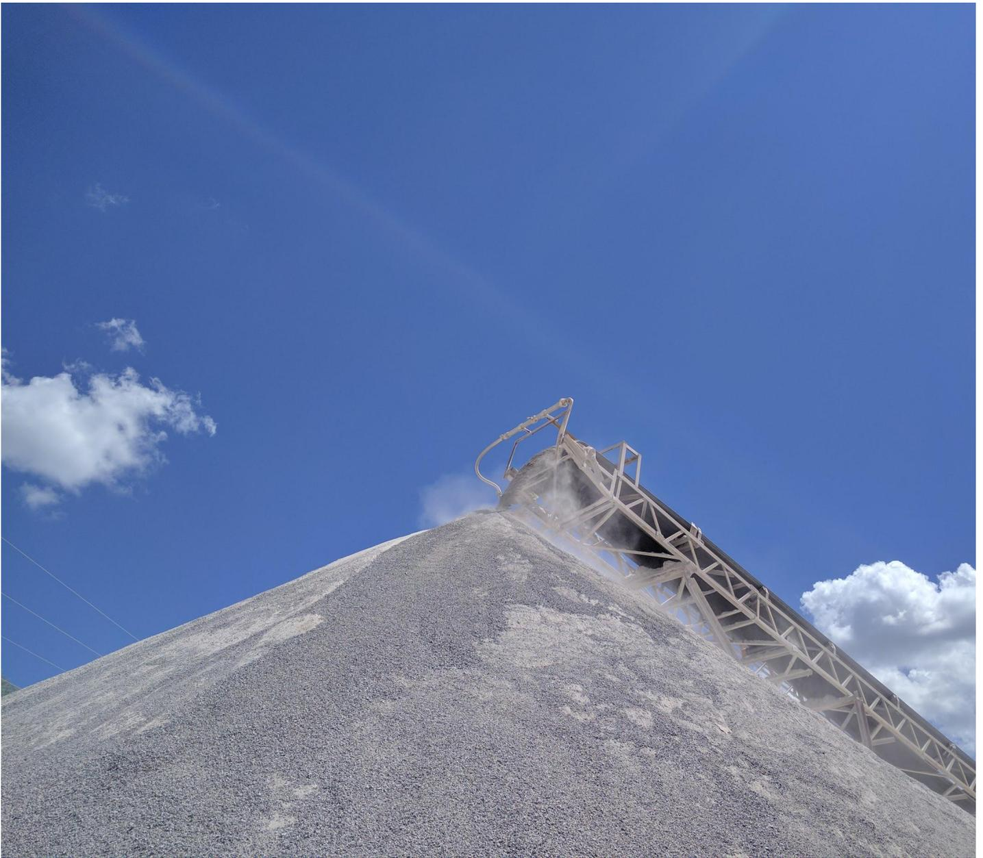
**Figura 14** - Pontos de lançamento das correias transportadoras das rochas britadas.
