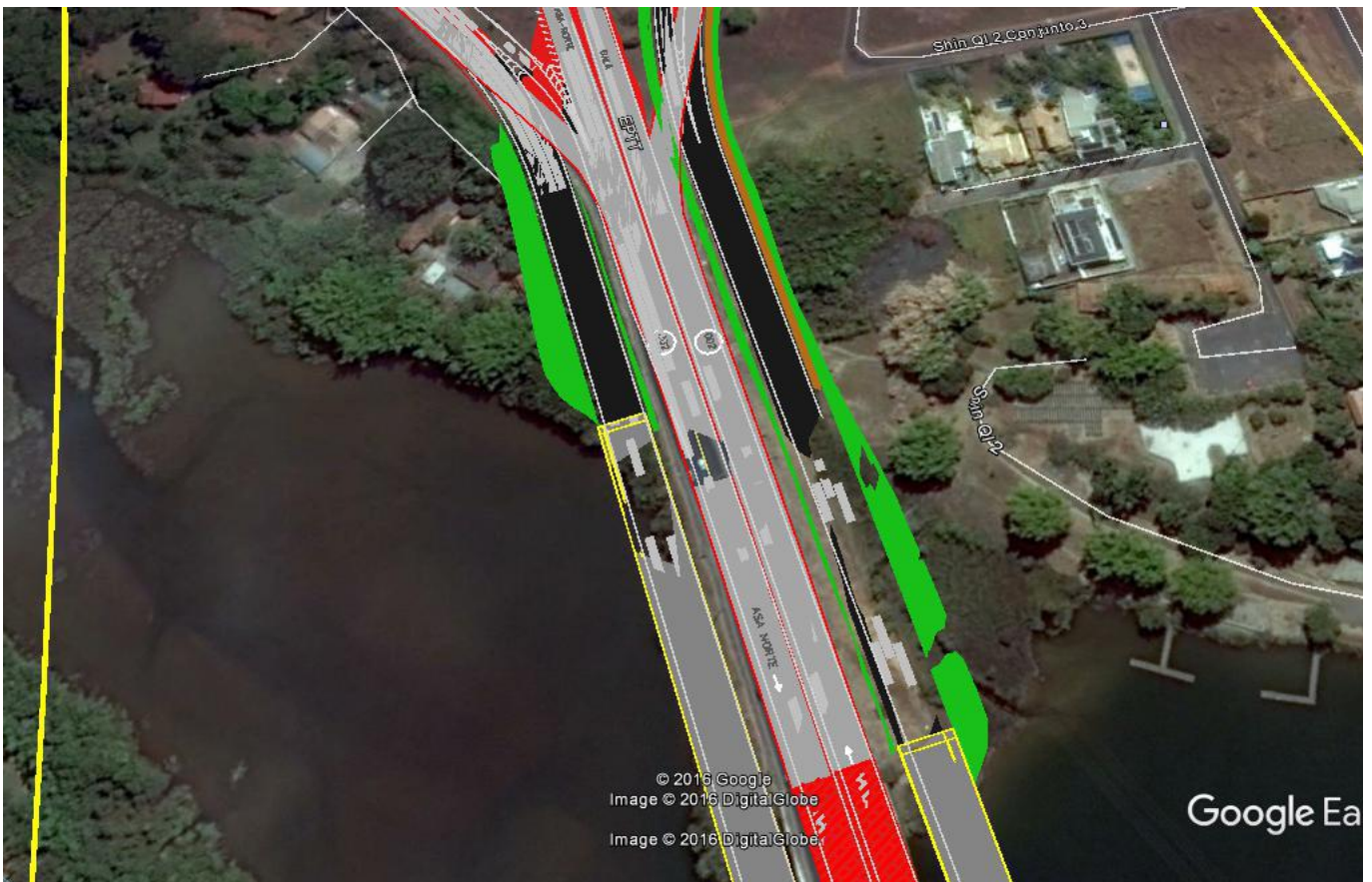
Figura 02- Aterro da ponte destacado em verde.
